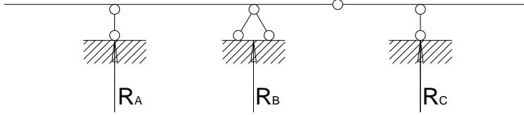
27. Трехпролетная статически определимая балка (см. рисунок) загружена сосредоточенной силой  $F$ . Построить эпюры изгибающих моментов и поперечных сил.
